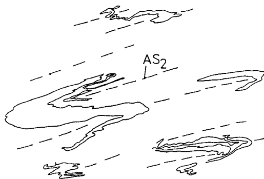
Obr. 10. Modifikácia vrás AF_2 sekrečného kremeňa a kremeňa Q_3 , rozstrih zámkov vrás, tvorba klivážových vrás na ramenách vrás AF_2 a vznik foliačných plôch AS_2 , identických s osovými rovinami AOR_2^{D2} .
